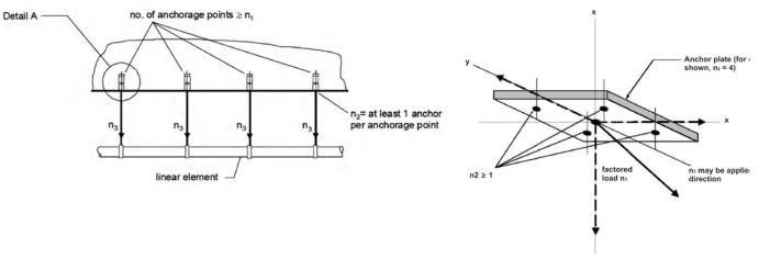
FIGURE 5—REDUNDANT FASTENING APPLICATION REQUIREMENTS FOR STRENGTH DESIGN OF TYPICAL FIXTURES
